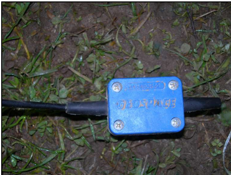
Fig. 4: Particolare del geofono e del connettore
