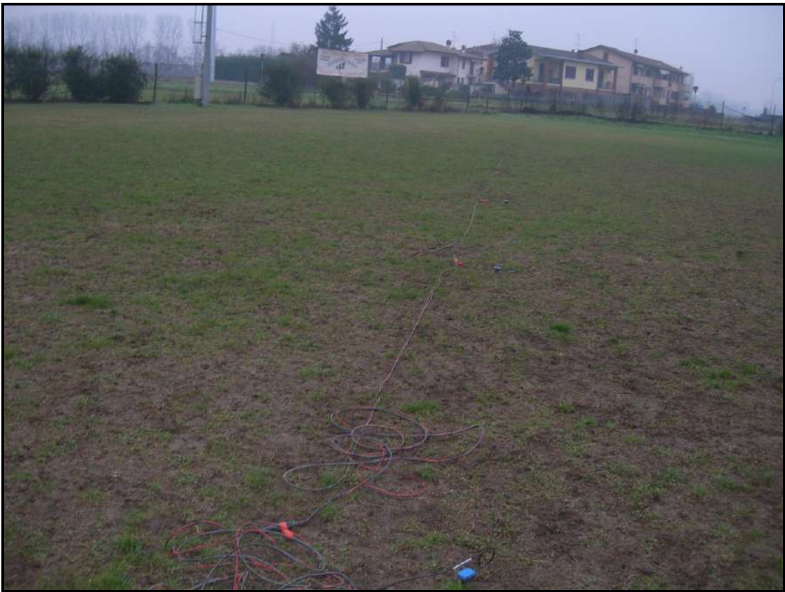
Fig. 1: Particolare dello stendimento sismico a Truccazzano
