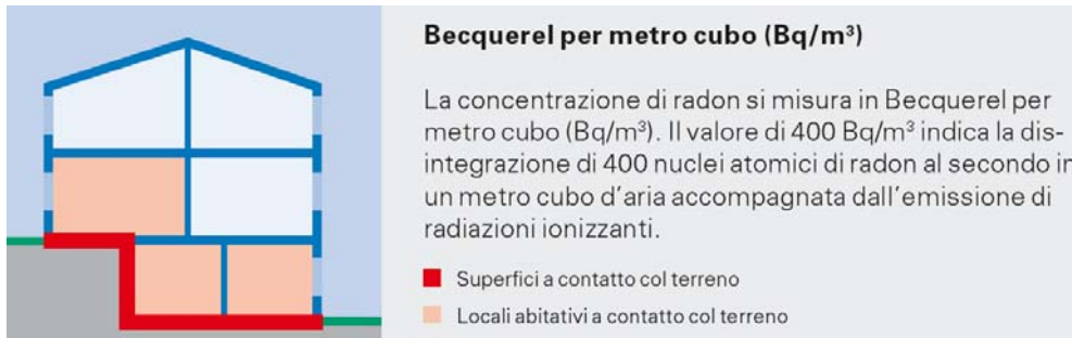
Unità di misura Bq/m 3 per la concentrazione di radon
