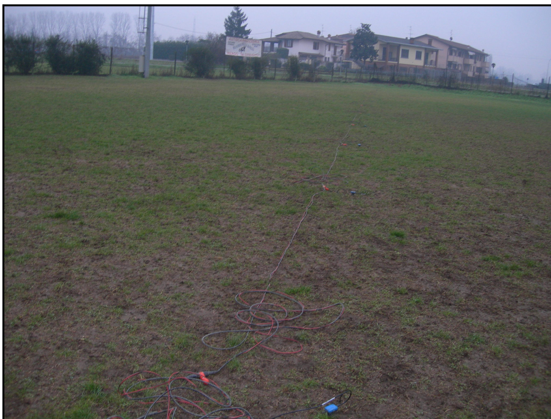
Fig. 1: Particolare dello stendimento sismico a Truccazzano
