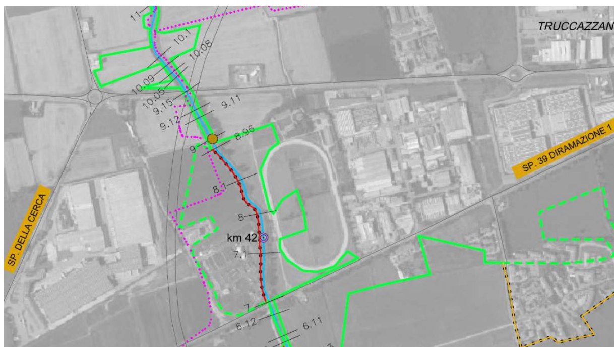
Fig. 1.51 – Tracciato dell'argine previsto dallo Studio di Fattibilità (aggiornamento 2016) presso il depuratore (linea rossa). Il pallino giallo indica un intervento di adeguamento del ponticello a monte del depuratore (indicato come "inadeguato ma compatibile").
